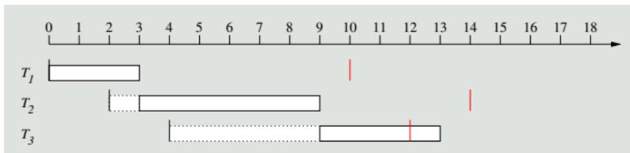
⚠ EDF versagt bei diesem System (**Achtung: A7 außer Kraft<sup>2</sup>**)
